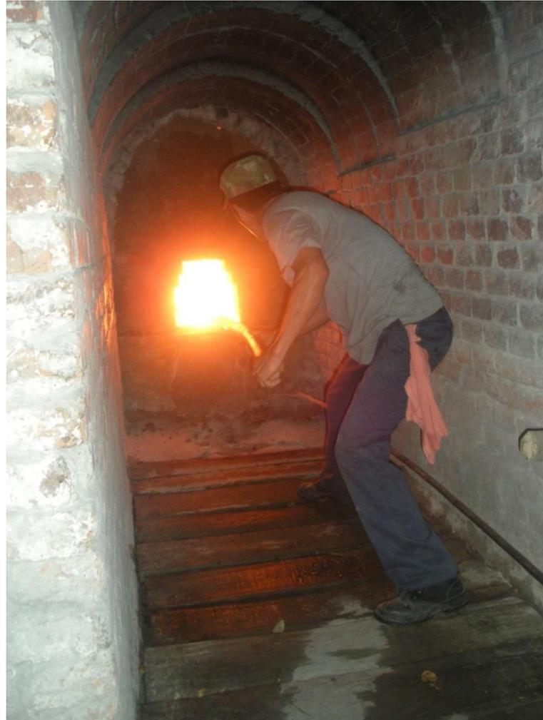
El “tubeado” del horno que se lleva a cabo después de ser cargado y tiene por fin avivar el fuego con lo que se intensifica la cocción y se eleva la temperatura
