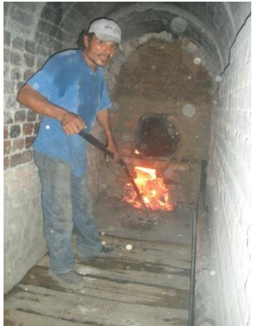
El barrido del horno consiste en la limpieza o retiro de los carbones de la parrilla operación en la que se emplean **el rastrillo y la pala de desbrazar**; con el primero, desde el oído superior, se recogen o amontonan los carbones junto a la compuerta; con la segunda, por el oído inferior, se retiran con la pala de desbrazar
