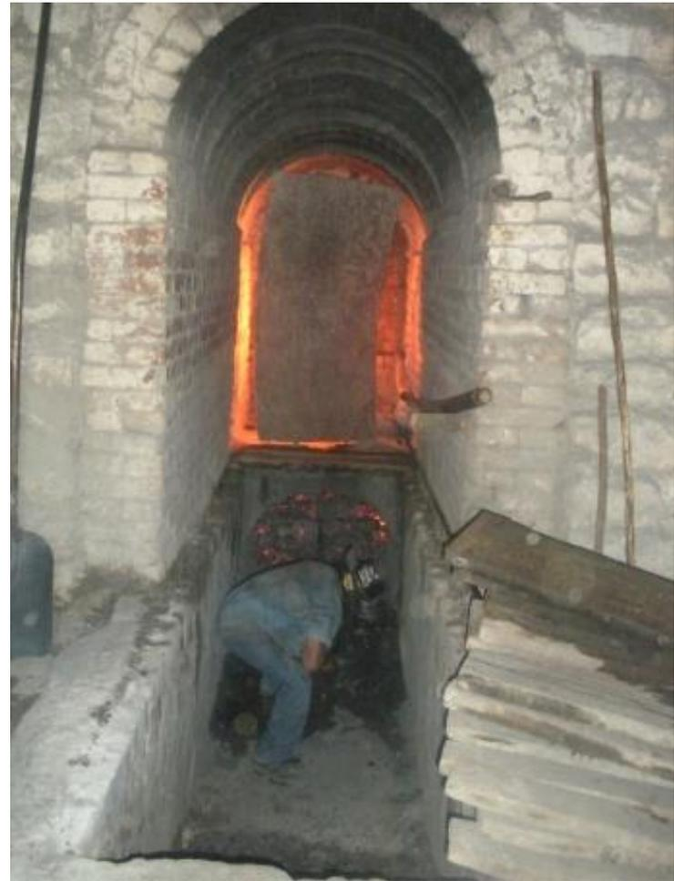
En el “jalado del cárcamo” se utiliza el rodillo y se realiza través de la bovedilla que sigue a continuación del cáncamo, tiene por fin retirar los residuos de la combustión que caen en medio de las juntas de los rieles que conforman la parrilla.
