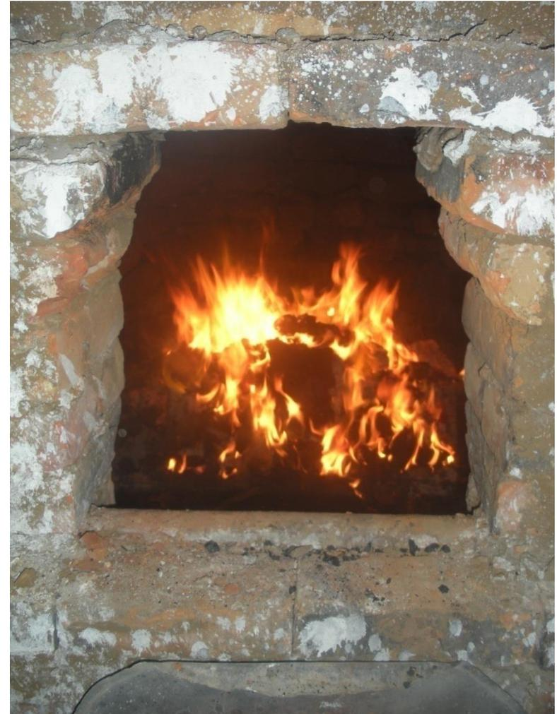
En el segundo turno se comienza a agregar la leña que “levanta la llama” y permite el “calentado” del horno.
