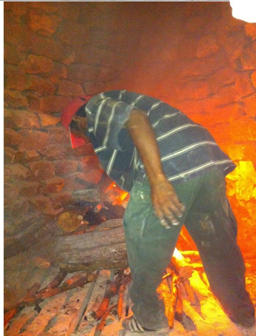
Durante el primer turno solo se utilizan carbones que permiten un calentamiento gradual del horno.
