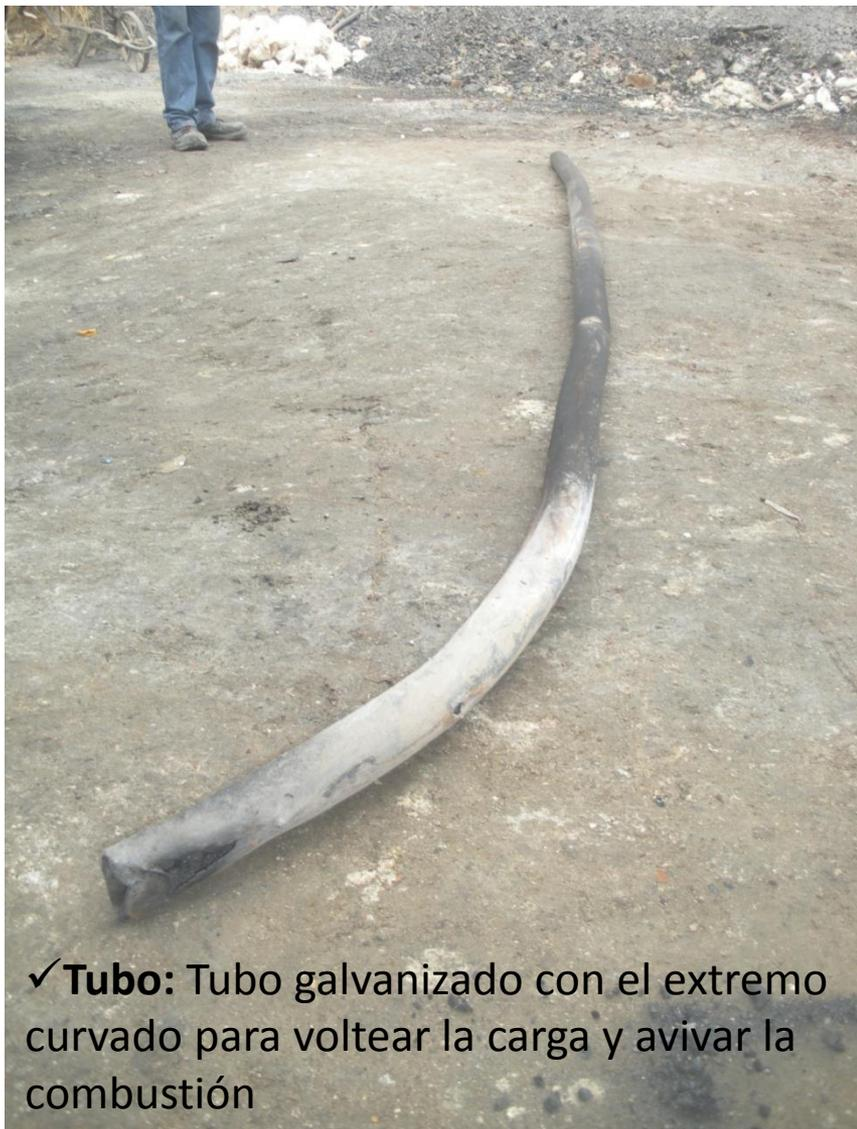
✓ **Tubo:** Tubo galvanizado con el extremo curvado para voltear la carga y avivar la combustión
