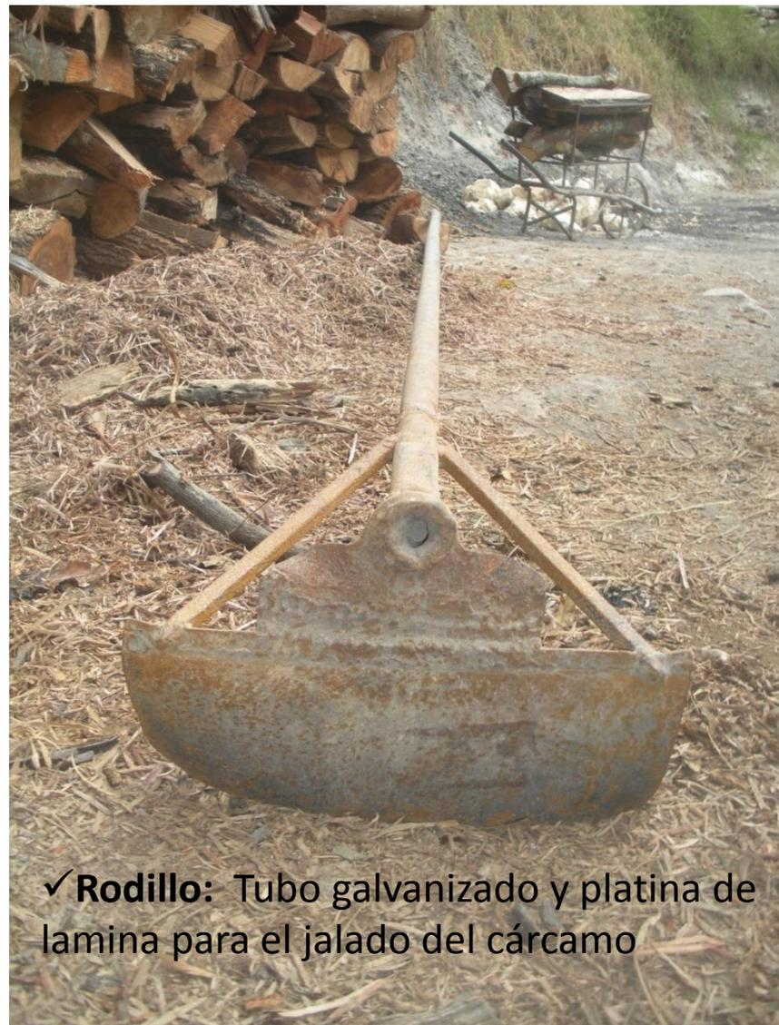
✓ **Rodillo:** Tubo galvanizado y platina de lamina para el jalado del cárcamo
